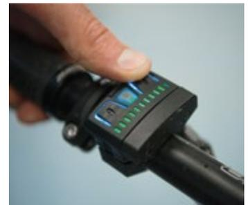
**Preisgekröntes Design:** Stabil und kompakt verrichtet der evation-Antrieb seine Arbeit (o.). Die Energie liefert das Drivepack, das sich komplett im Rahmen versteckt (M.). Das einzige sichtbare Element ist die Steuerung, mit der sich die Unterstützung durch den Antrieb einstellen lässt (u.).
