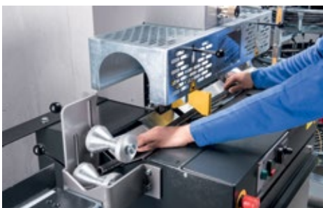
Schritt 1: Ablängen von Schläuchen
