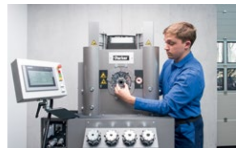
Schritt 3: Verpressen der Schlaucharmaturen
